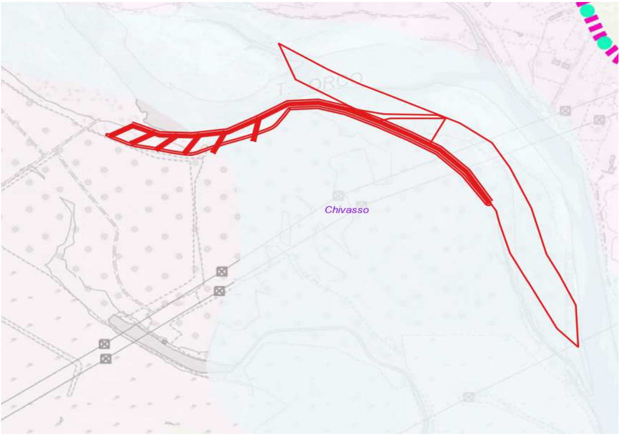
Figura 7: PRG Chivasso: stralcio Tav.2.4 “Sintesi della pericolosità geomorfologica e dell’idoneità all’utilizzazione urbanistica” con sovrapposizione delle aree interessate degli interventi (in rosso).
